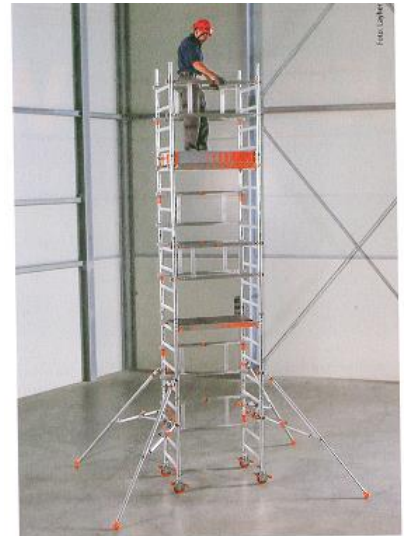
Auch fahrbare Arbeitsgerüste gehören in den Geltungsbereich der neu gefassten TRBS 2121.
