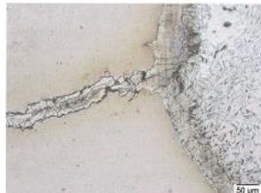
Mikroschnitt durch einen mit Zinkphase gefüllten Nebenriss.
