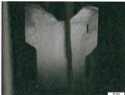
Makroschnitt durch eine geschädigte Schweißverbindung, mit Zink gefüllter Riss und Spalt zwischen zwei Fügeanteilen.
