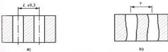
Exemplarische Veranschaulichung der Mehrdeutigkeit der Plus-Minus-Tolerierung einer linearen Abstandsbeziehung zwischen zwei Mittellinien. (Die Mehrdeutigkeit der Zeichnungseintragung im Bild a) ist im Bild b) gezeigt.)
