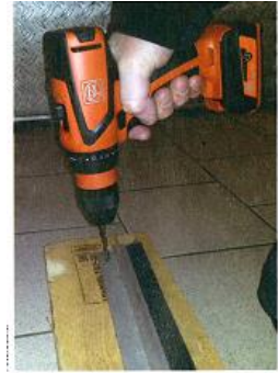
Der Vier-Gang-Akku-Bohrschrauber ASCM 12 C wurde beim Test auch für die Montage von Bürstendichtungen eingesetzt.
