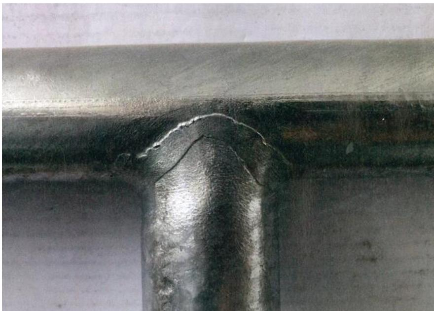
So kann eine Zinkverdickung im Bereich der Schweißnaht aussehen. Ohne Feinverputzen ist diese Unregelmäßigkeit auch nach der Farbbeschichtung eindeutig erkennbar (Quelle: M&T 10.2020)
