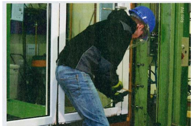
Prüfung eines einbruchhemmenden Fensters im Prüfinstitut Schlösser und Beschläge Velbert (PIV).
