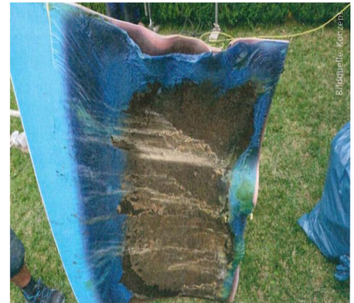
Die PVC-Platten in den Paneelen wurden durch die hohen Temperaturen verbrannt und deutlich verformt
