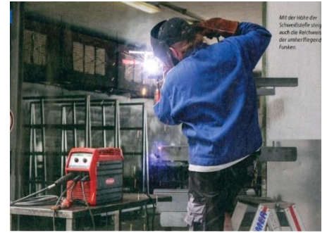
Mit der Höhe der Schweißstelle steigt auch die Reichweite der umherfliegenden Funken.
